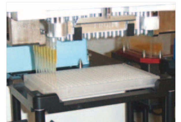
Pipettier-Roboter für präzise Hochdurchsatzeinsätze in der täglichen Laborarbeit.
