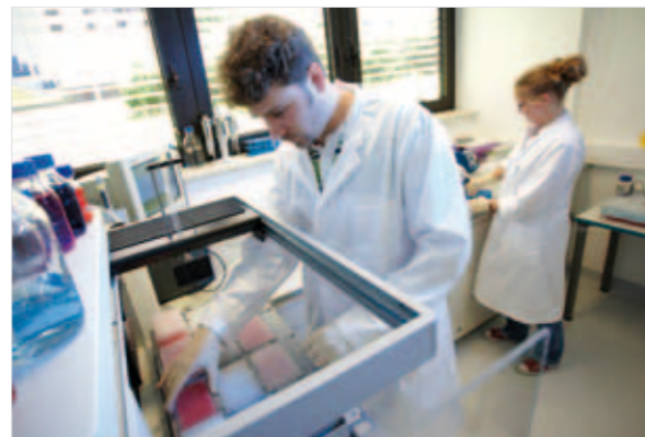
Automatisierung im Labor, Vorbereitung genetischer Untersuchungen mittels Pipettier-Roboter (Thomas Feulner, Cynthia Schiller).
